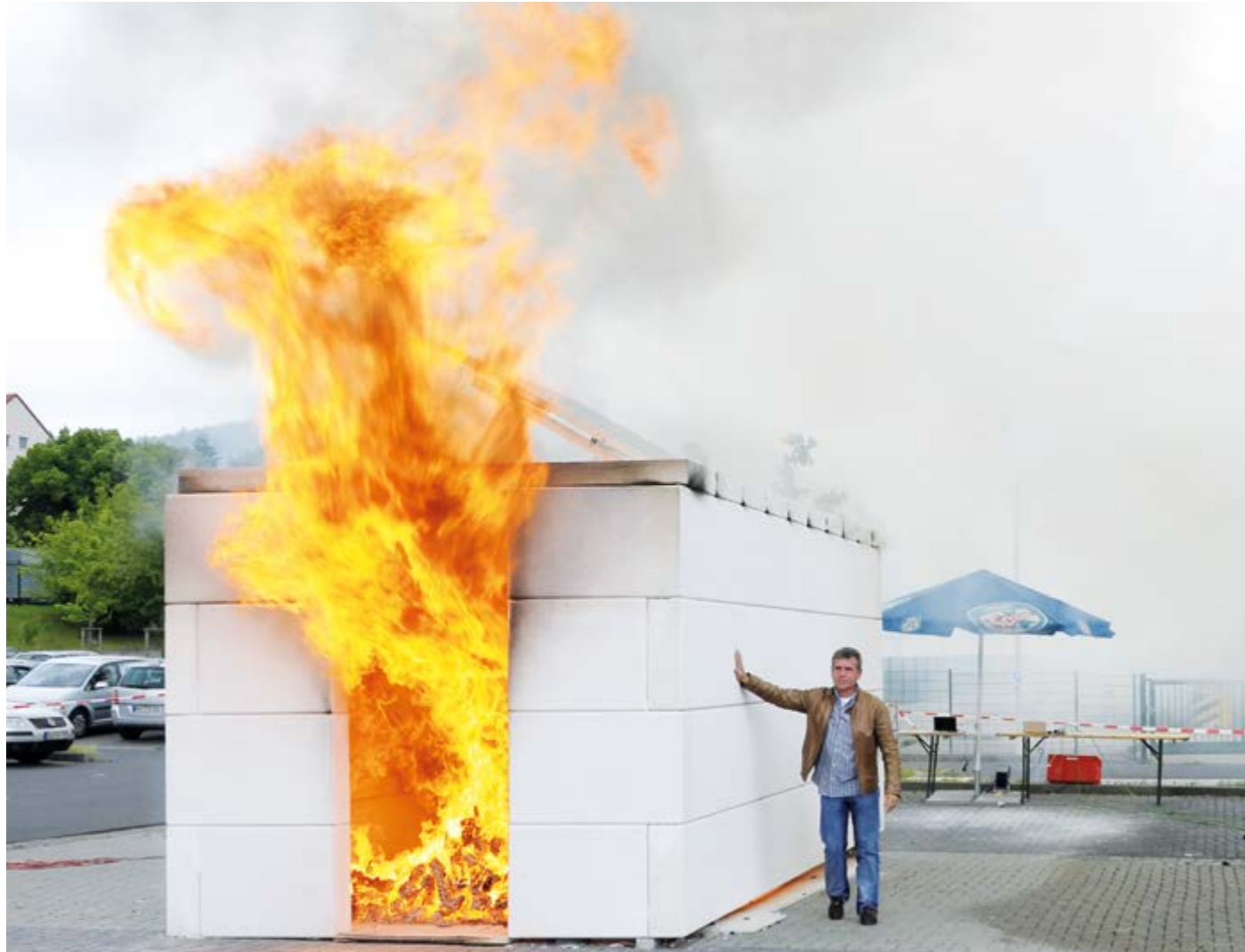
Fotoğraf: Karlsruhe Teknik Üniversitesi Ytong Donatılı Panel Yanma Deneyi, Format Dergi-15, Nisan 2010 www.xella.de
